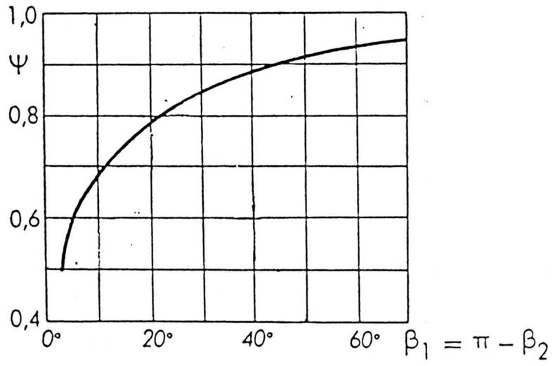
Figura 22: Coefficiente di perdita della girante
