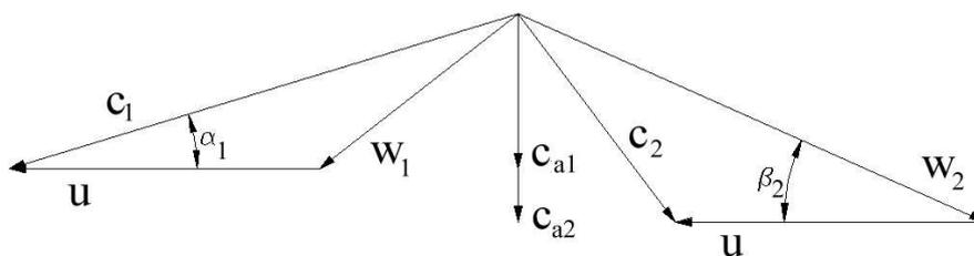
Figura 28: Triangoli di velocità
