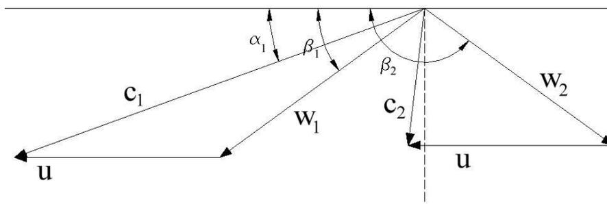
Figura 20: Triangoli di velocità
