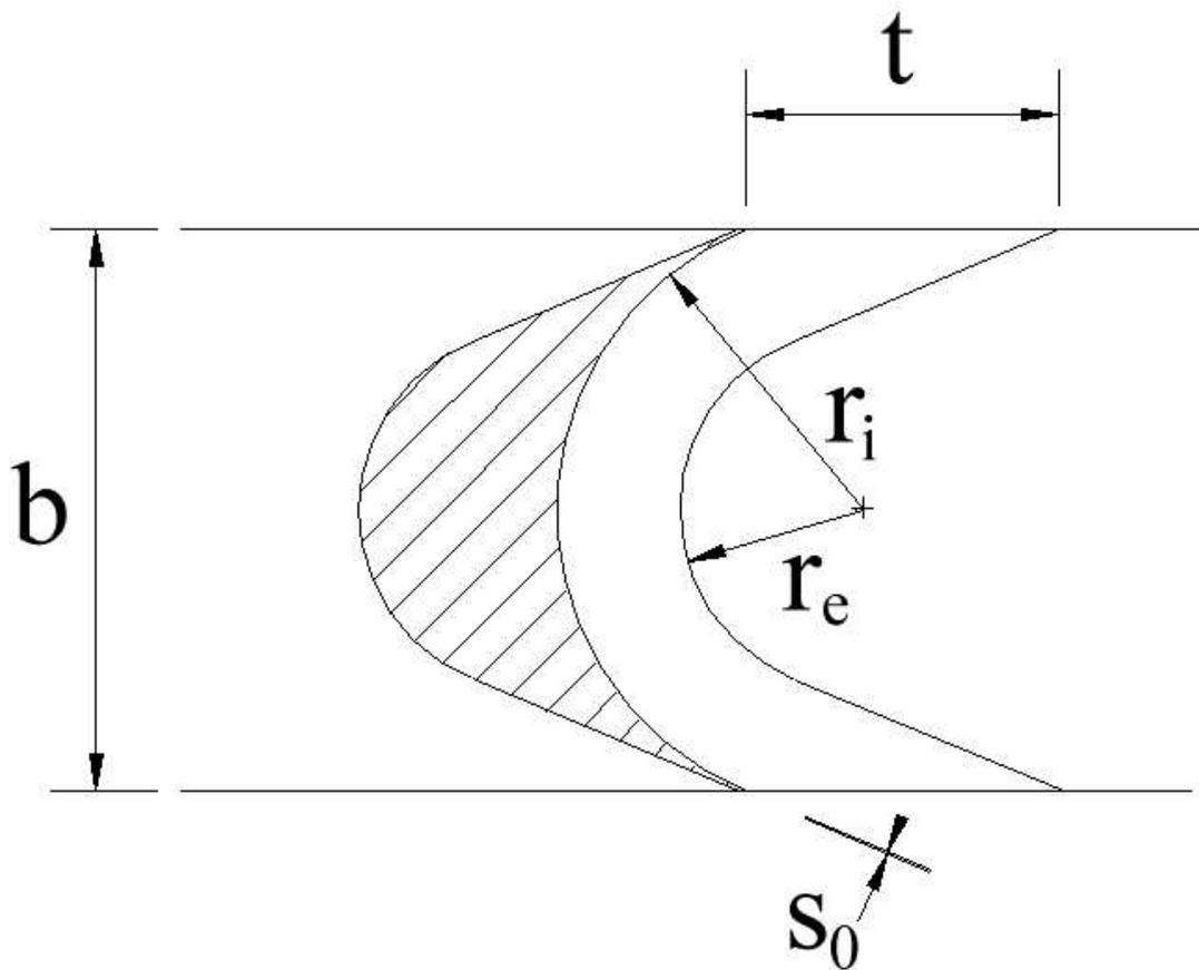
Figura 26: Geometria delle pale della prima girante
