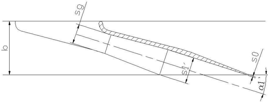
Figura 25: Geometria di un ugello distributore
