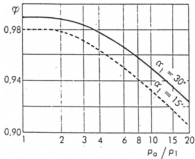
Figura 21: Coefficiente di perdita del distributore
