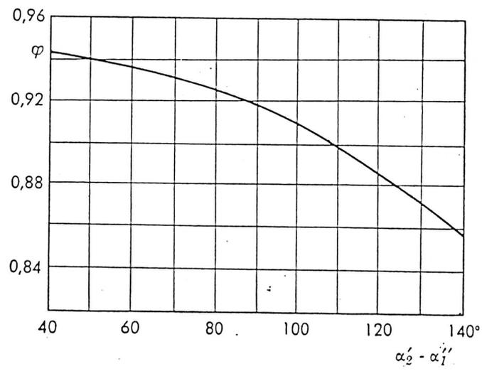
Figura 23: Coefficiente di perdita del raddrizzatore
