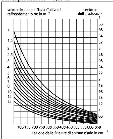
**Fig. 5.2 - Fattore di ripartizione di temperatura  $c$  per involucri senza finestre di ventilazione e con una superficie effettiva di raffreddamento  $A_e > 1,25 \text{ m}^2$**
