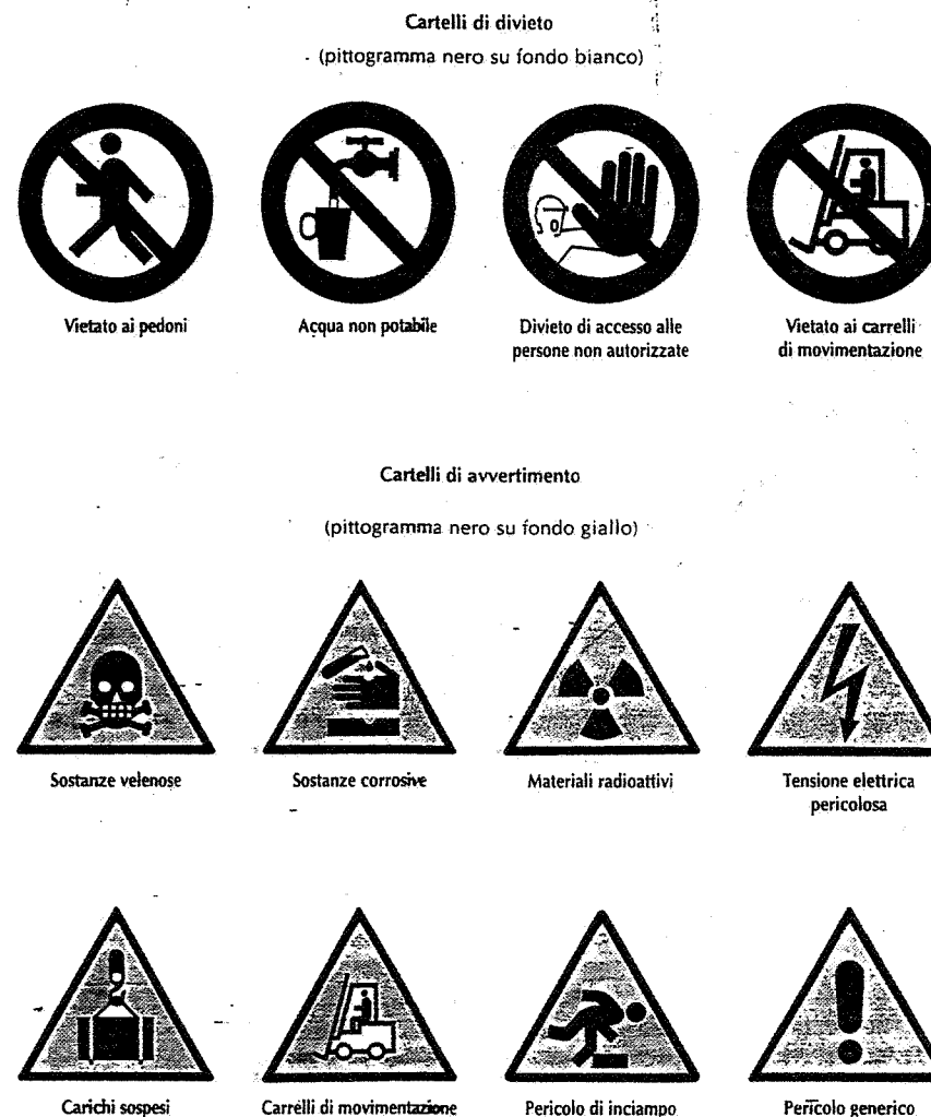
Fig. 53.10 - Segnaletica di sicurezza e di salute sui luoghi di lavoro (D. Lgs. 14 agosto 1996, n. 493).
