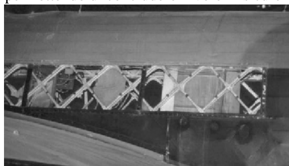
Fig. 1.16: Struttura geodetica (fusoliera di Vickers Wellington)
